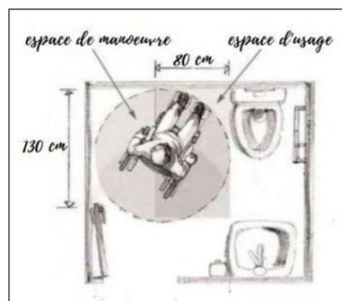
8. La cuvette est-elle à une hauteur comprise entre 0,45 et 0,50 m ?
